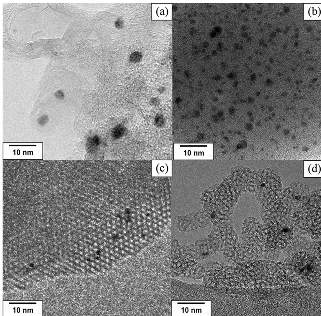
Figure 3. TEM scans for (a) Pt-Bi/AC, (b) Pt-Bi/ZSM-5, (c) Pt-Bi/MCM-41, and (d) Pt-Bi-MCM-41.
