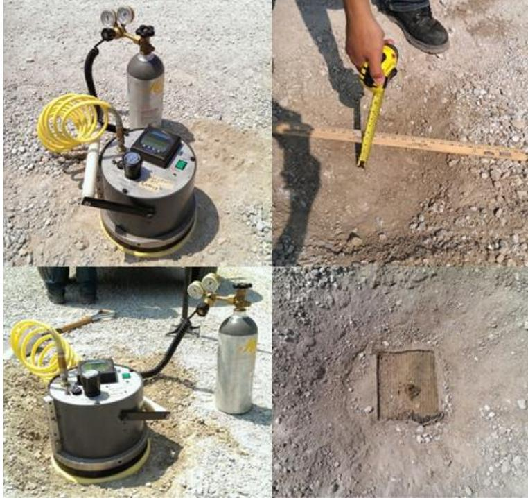
**Figure 17. Air permeameter test**
